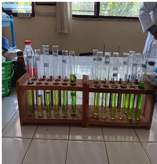
Gambar 3. Ekstraksi Klorofil Pada Daun Tabulampot Belimbing untuk selanjutnya Diuji Dengan Alat Spektrofotometer UV-VIS
