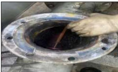
Gambar 11 Proses Pembersihan Bagian Dalam Komponen *Eductor Pump*
