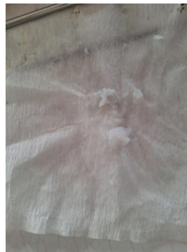
Gambar 1. Endapan \text{Mg(OH)}_2 halus seperti susu yang berwarna putih Sebanyak 1,60 gram
